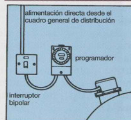
Fig. 134 Instalación de un calentador con incorporación de un interruptor bipolar de 20 amperios y un programador.
